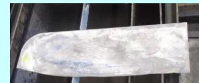
Wを含む様々なスクラップを前処理（粉碎、調整）を行い、専用炉で効率良く、酸化焙焼処理を実施⇒ **回収（焼鉍）**
