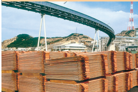
写真：電気鋼（直島製錬所）
