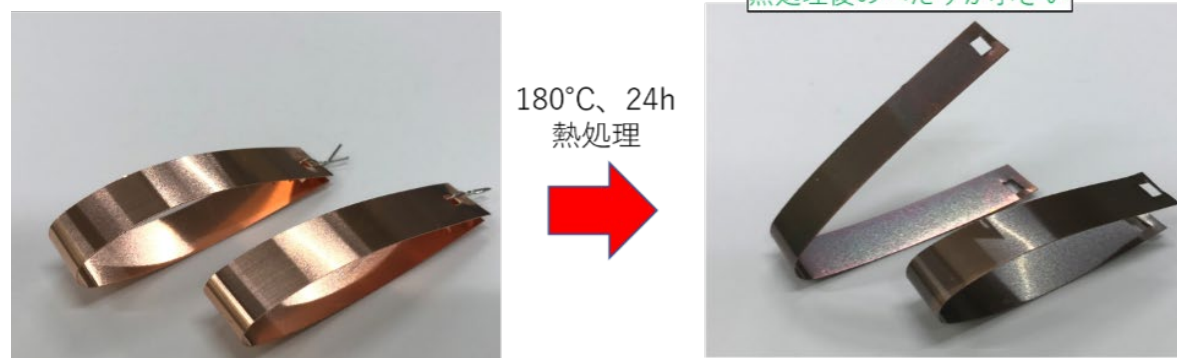
新規開発のMOFC-HR xEV用途の大電流用のブスバー・端子などに最適
