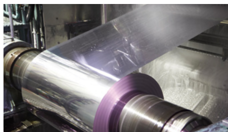
■三菱アルミニウム社の箔圧延工程
